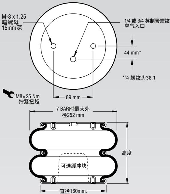
注：图示为缘板气囊。此零件也可提供缘环结构。参见第8-10页的说明。
