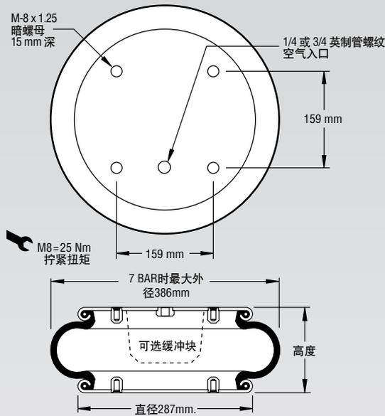
注：图示为缘板气囊。此零件也可提供缘环结构。参见第8-10页的说明。
